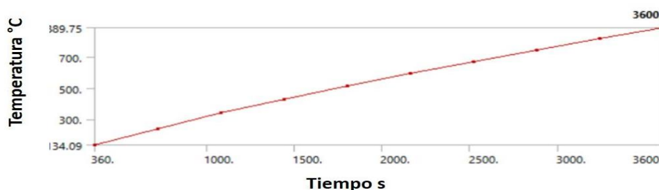
Figura 2.5. Grafica de la distribución de temperatura en el crisol de la mufla de 100 mm.
