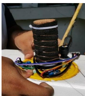
Figura 4.1. Montaje de la tapa instrumentada con el cátodo de fieltro con aglutinante n-pirrolidona y óxido de manganeso. Fuente: propia
